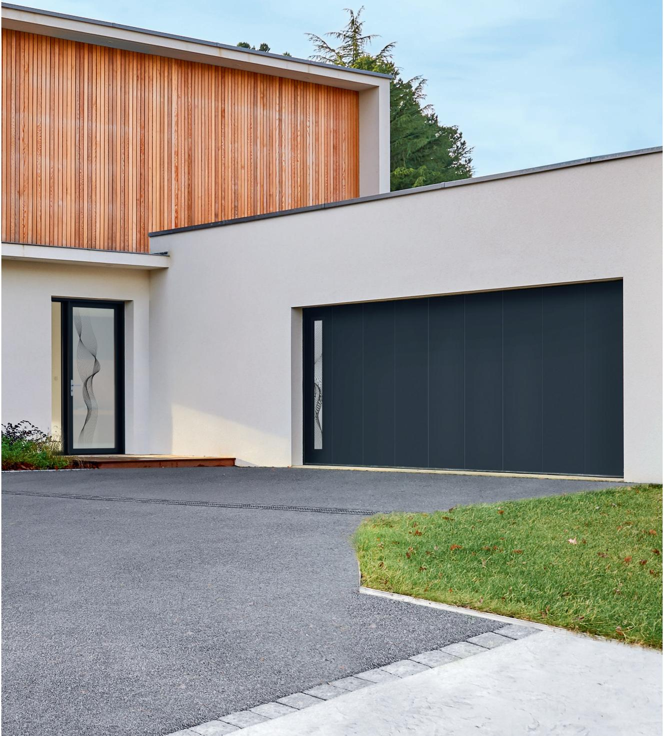
En neuf comme en rénovation, la porte de garage latérale se déplace le long d'un mur intérieur, c'est une solution idéale pour les garages avec peu de hauteur. L'ouverture latérale impose de libérer le pan de mur où refoulera la porte.
